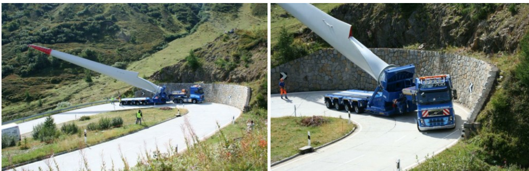
Abbildung 7: Spezialtransport für eine Windenergieanlage am Griespass (CH).
